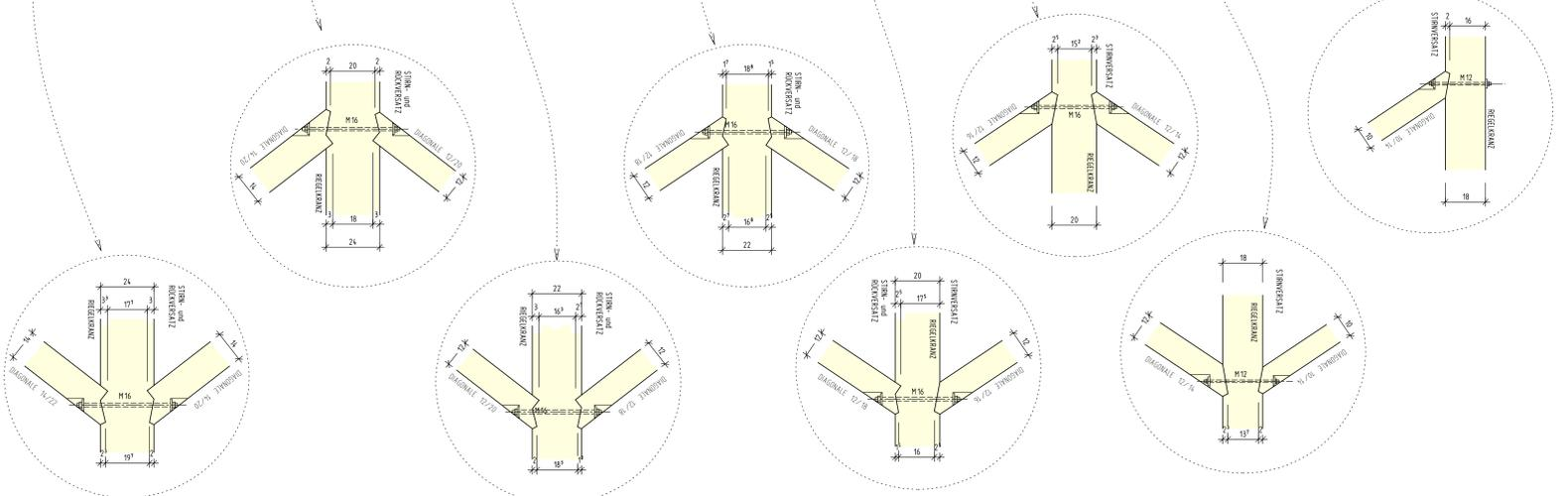
GRATSPARREN in BS11, ALLE ANDEREN BAUTEILE IN KONSTRUKTIONSVOLLHOLZ KVH S10 ALLE STAHLBAUTEILE FEHRLERZINKT
